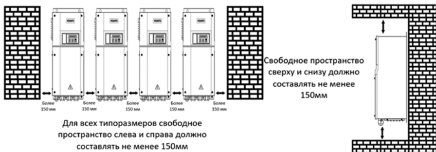
Рисунок 3.7-2. – Рекомендуемые монтажные расстояния для преобразователей частоты VF-101 HBC
