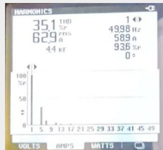
Сигналы напряжения и тока, а также коэффициент искажения тока THD перед добавлением
