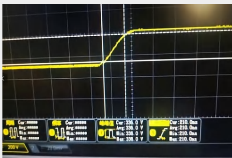
Изначальное значения du/dt: 1600 В/мкс Отфильтрованное значение du/dt: 84.5 В/мкс
