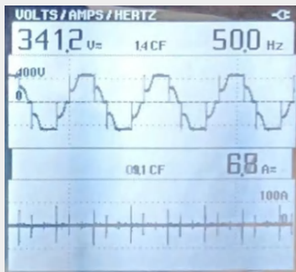
Сигналы напряжения и тока, а также коэффициент искажения тока THD перед добавлением
