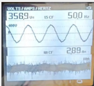
Сигналы напряжения и тока, а также коэффициент искажения тока THD после добавления
