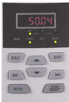
Рис. 4-7. Режим прямого изменения частоты
