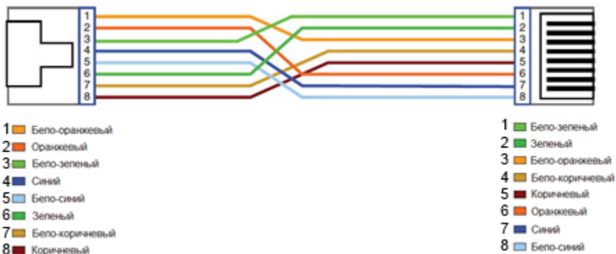
Рис. 12 Разводка кабеля по типу TIA/EIA-568-B.
