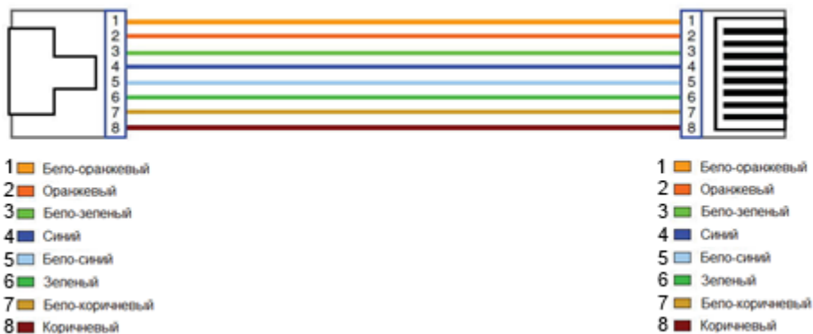
Рис. 10 Разводка кабеля по типу TIA/EIA-568-A.
