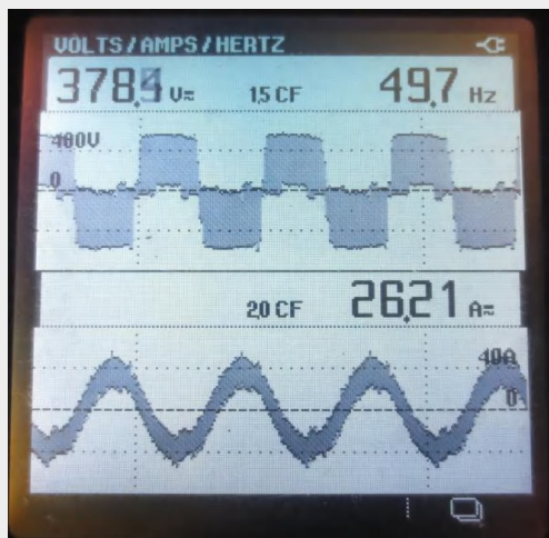
Сигналы тока и напряжения до добавления синус фильтра
