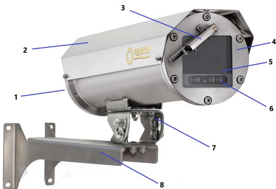
1 – основание с выходами под кабельные вводы; 2 – солнцезащитный козырек; 3 – стеклоочиститель; 4 – лицевая панель; 5 – смотровое окно; 6 – ИК-подсветка; 7 – болт крепления крепежно-юстировочного устройства; 8 – крепежно-юстировочное устройство. Рисунок 2 – Внешний вид термокожуха Релион-ТКВ-400-Н-ИК-СО
