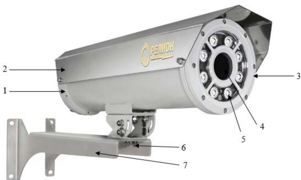
1 – основание с кабельным вводом; 2 – солнцезащитный козырек; 3 – лицевая панель; 4 – ударопрочные смотровые окна; 5 – ИК-подсветка; 6 – болты крепления крепежно-юстировочного устройства; 7 – крепежно-юстировочное устройство. Рисунок 3 – Внешний вид термокожуха Релион-ТКВ-400-М-ИК
