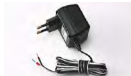
Фото 18. Внешний блок питания электропривода от сети 220 В
