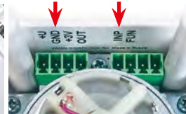
Фото 13. Клеммы подключения проводных датчиков — INP, GND
