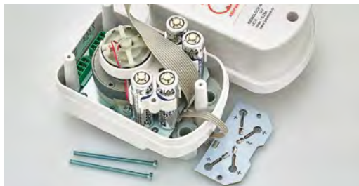
Фото 17. Контактная площадка снята, батарейки могут быть заменены
