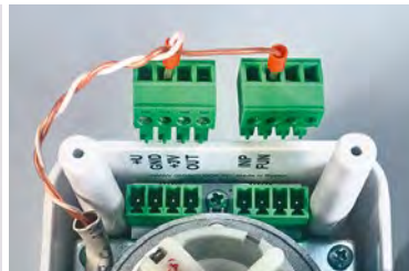
Фото 22. Подключение проводного выключателя
