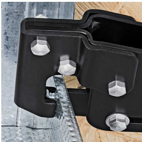
Пуансон инструмента продавливается через профили
