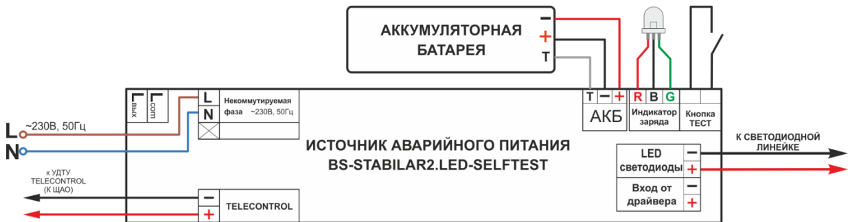
Рис. 2 Схема подключения БАП для аварийного светового прибора в непостоянном режиме:
