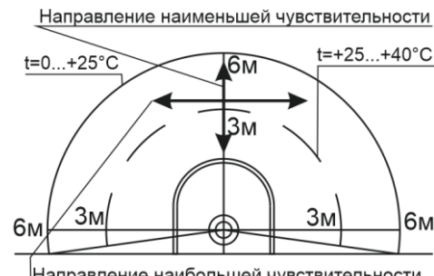
Рис. 8 – Радиус действия датчика в горизонтальной плоскости
