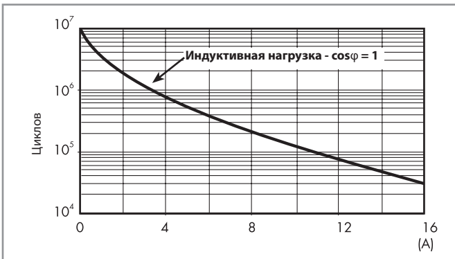
F 45 - Электрическая долговечность (AC) при ном. нагрузке тип 45.31/45.91
