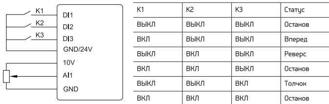
Рисунок 3.18 – Схема управления преобразователя с клемм
