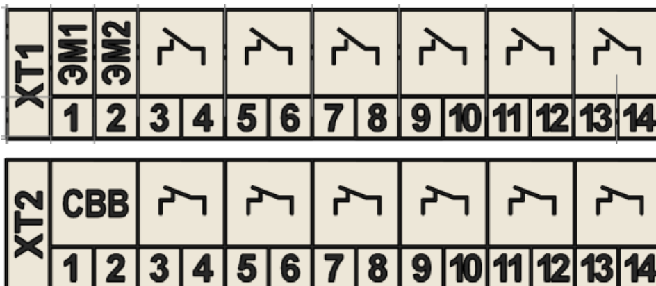
Рисунок 5. Обозначение разъемов вторичной коммутации коммутационного модуля
