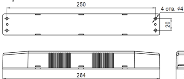
Рис.7 Габаритные и присоединительные размеры источника аварийного питания STABILAR.LED
