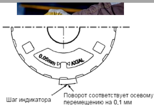
Рисунок 13 (Осевое перемещение рабочего колеса)
