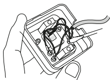
3.4. Подсоединить предварительно зачищенные провода к контактам розетки, затянув винты.
