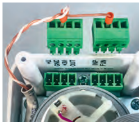
Фото 18. Подключение проводного выключателя к электроприводу
