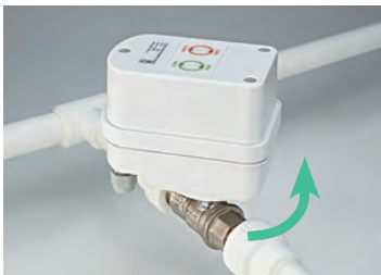
Фото 27, 28, 29. Ручное управление шаровым краном. Удаление металлического фиксатора для отсоединения электропривода от шарового крана и ручного управления шаровым краном.
