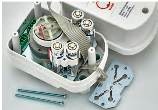
Фото 31. Контактная площадка снята, батарейки могут быть заменены
