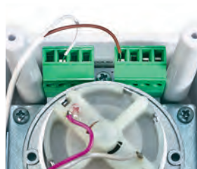
Фото 11. Подключение датчика к электроприводу
