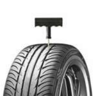
вставить в отверстие рашпиль, расширить образовавшуюся полость
