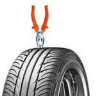
удалить предмет, повредивший шину
