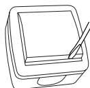
Рисунок 1. Снять клавишу при помощи наконечника плоской отвертки.
