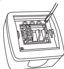
Рисунок 2. Вывернуть два самореза и снять крышку изделия.
