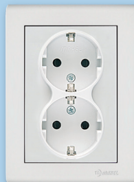
41001057 Розетка 2-я с заземлением (новый дизайн) Напряжение 250V Сила тока 16A Степень защиты IP20
