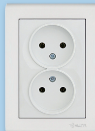
41001017 Розетка 2-я без заземления Напряжение 250V Сила тока 16A Степень защиты IP20
