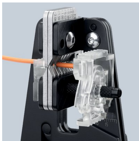
Ровное надрезание изоляции по всей окружности кабеля
