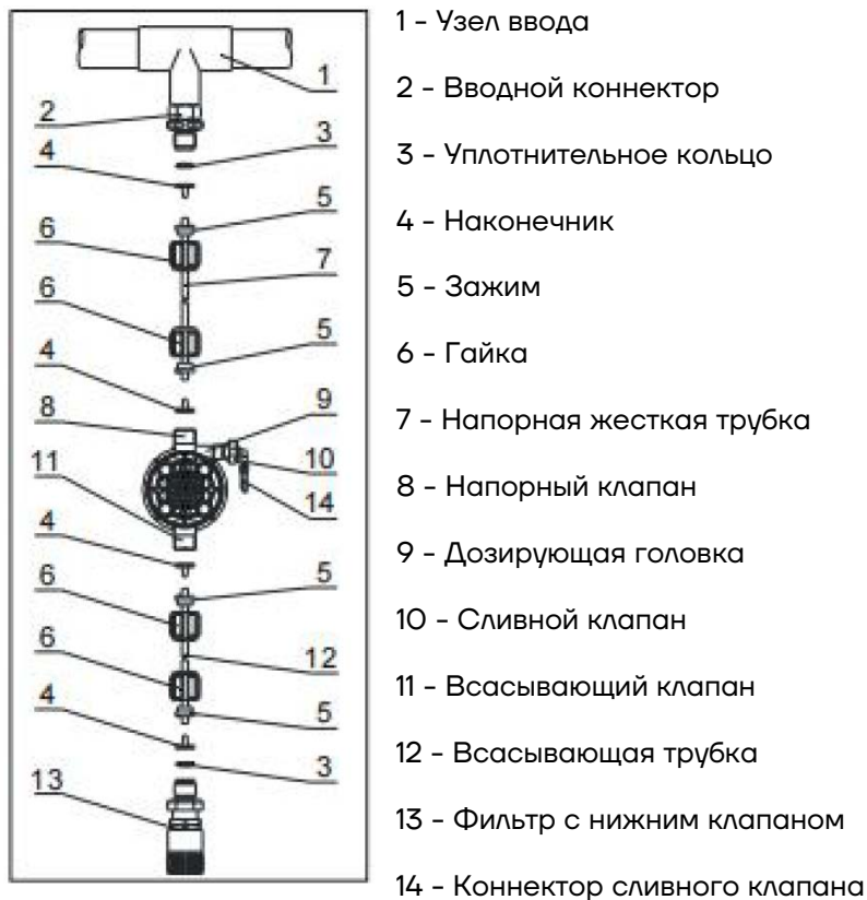
Рис. 3 Гидравлическое подключение.
