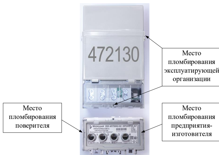
Рисунок 3.4 – Общий вид счетчиков «Меркурий 208» с индексами «М» и «Х» с указанием мест пломбирования и нанесения знака поверки
