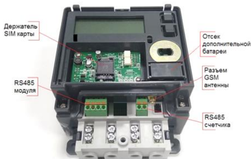
Рисунок 5.4 – Элементы подключения счетчика «Меркурий 204»
