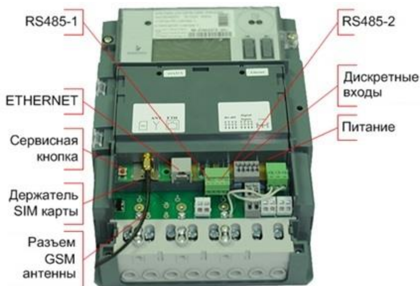
Рисунок 5.6 Элементы подключения модуля телемеханики
