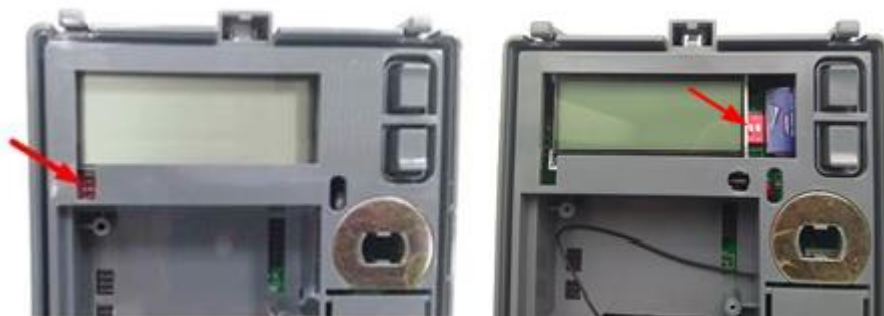
Рисунок 4.1 – Расположение переключателя блокировки управления нагрузкой счетчика «Меркурий 204»
