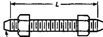
Высота вершины [Примечание (1)] Шпилька с гайками
