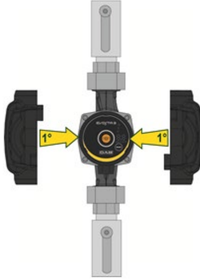
Resim 7: Pompa gövdesinin yalıtımı
