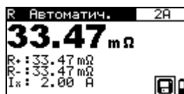
Рисунок 6.4: Примеры результата измерения сопротивления
