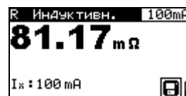
Рисунок 6.4: Примеры результата измерения сопротивления
