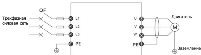
Рисунок 3.19 – Схема подключения для ввода в эксплуатацию
