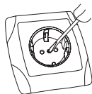
3.6. Установить центральную вставку и закрыть монтажный винт.
