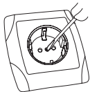
3.1. Вывернуть монтажный винт розетки отверткой и вынуть центральную вставку.
