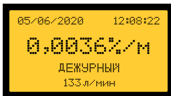
Рисунок 6 – Дисплей извещателя в дежурном режиме
