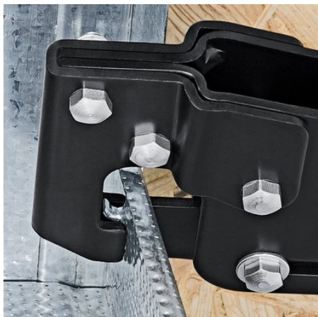
Пуансон инструмента продавливается через профили
