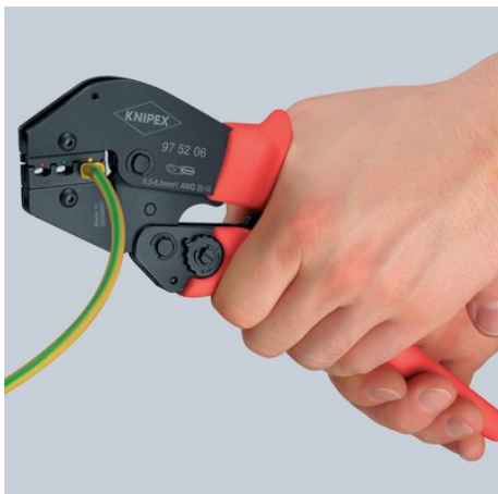
Третий этап: При необходимости увеличенного усилия опрессовки, например, для изолированных контактов. Второй этап: Теперь ручки сжимают для продолжения процесса опрессовки 6,00 мм 2 ; при наличии удлиненных ручек возможна работа обеими руками
