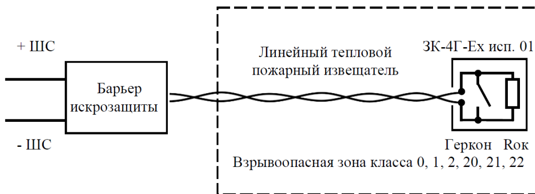
Рисунок 14. Схема подключения извещателя к барьеру искрозащиты и к зонной коробке ЗК-4Г-Ех исп.01
