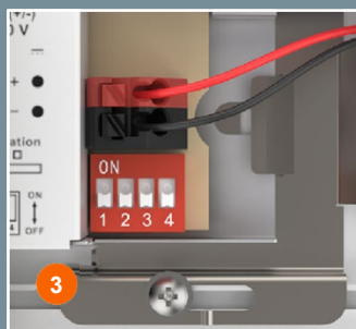
DIP-переключатель для простой настройки мощности
