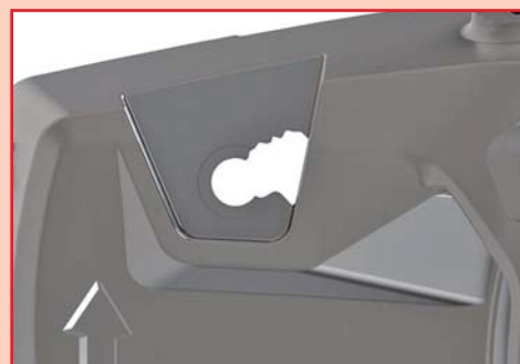
рис. 2 Излом корпуса редуктора
