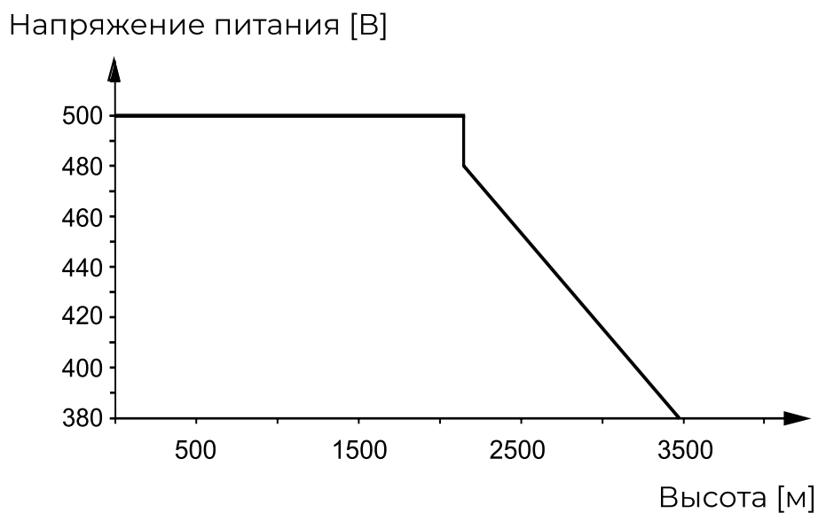
Рис. 13. Питающее напряжение для трехфазного электродвигателя в зависимости от высоты над уровнем моря
