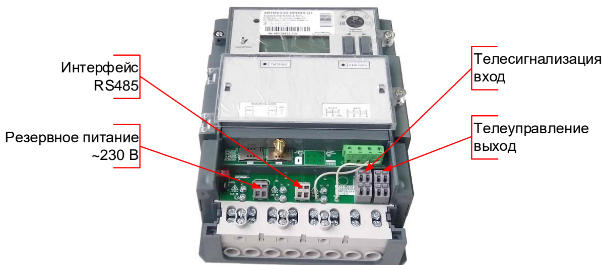
Рисунок 5.5 – Элементы подключения счетчика «Меркурий 234» с индексом «Х»
