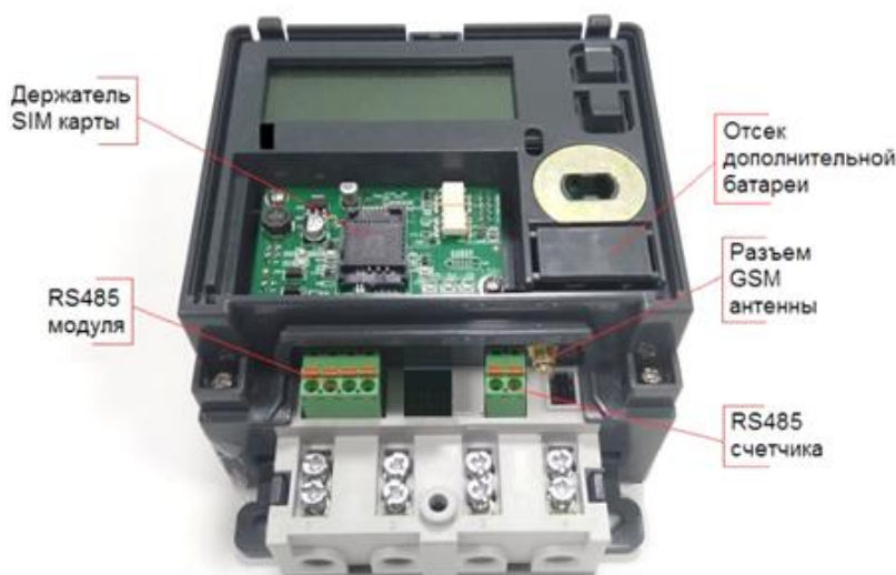
Рисунок 5.4 – Элементы подключения счетчика «Меркурий 204»
