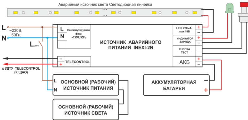
Рис. 1 Схема подключения BS-INEXI2-81-B2-LED и BS-INEXI2-83-B2-LED для аварийного светового прибора в универсальном режиме:
