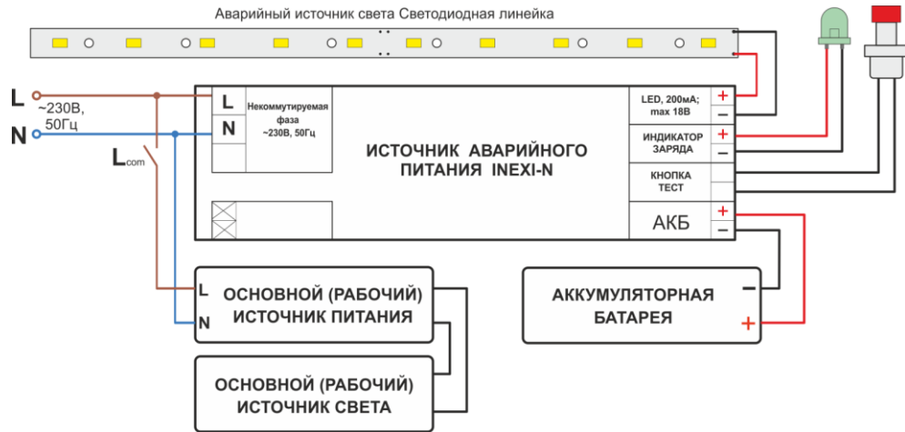
Рис. 2 Схема подключения BS-81-B1-LED и BS-83-B1-LED для аварийного светового прибора в непостоянном режиме:
