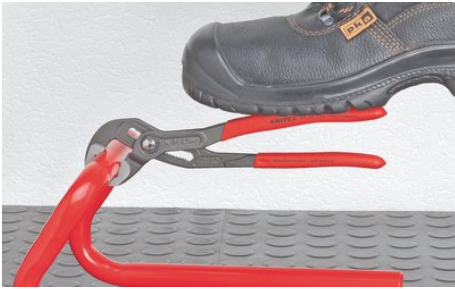
Смещенные против направления зубцы обеспечивают эффект самофиксации и предотвращают соскальзывание инструмента с детали.
