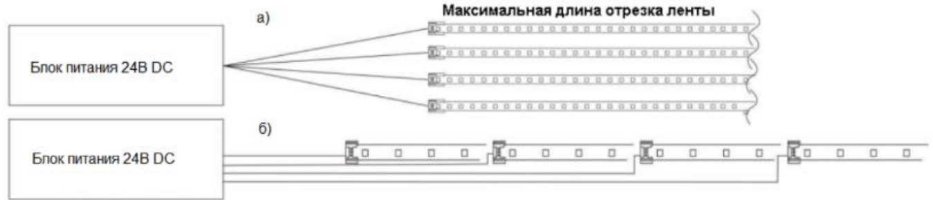
а) Шлейфовое подключение светодиодной ленты; б) подключение нескольких отрезков светодиодной ленты смонтированных в одну линию.
