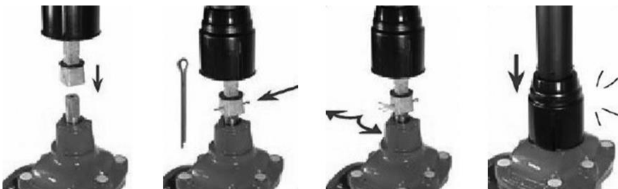
Рис. 4 Порядок установки телескопического штока на задвижку.
