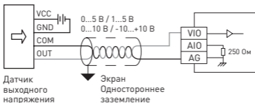
Рис. 4 – Подключение аналоговых входов (входной сигнал – напряжение)
