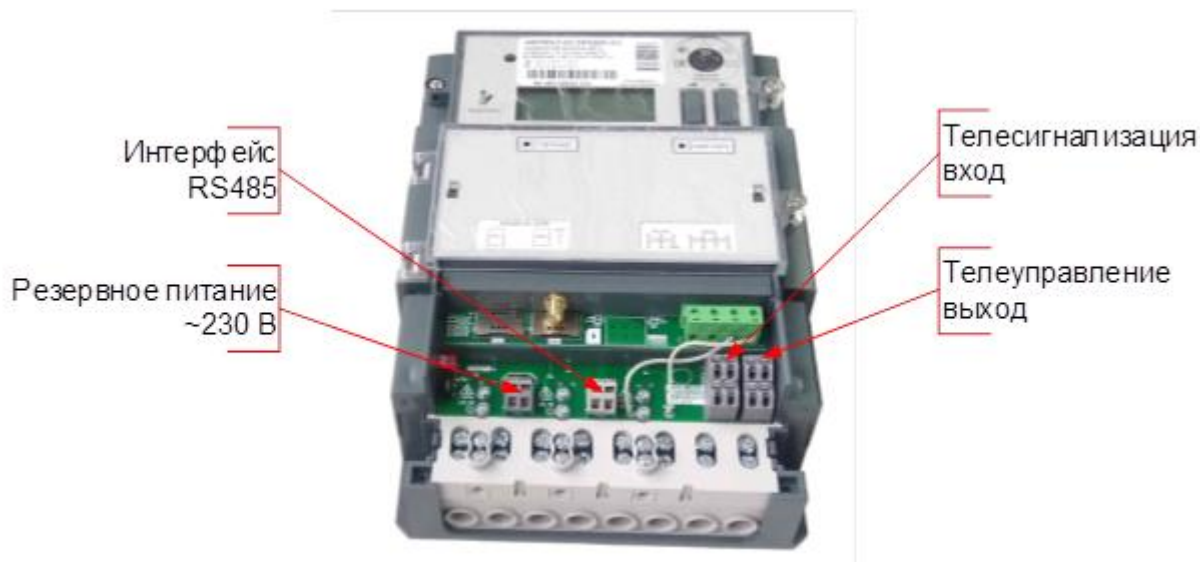
Рисунок 5.5 – Элементы подключения счетчика «Меркурий 234» с индексом «Х»
