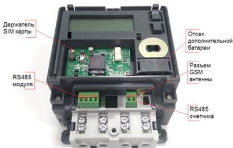
Рисунок 5.4 – Элементы подключения счетчика «Меркурий 204»
