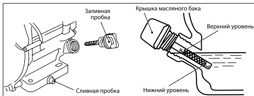
Рисунок 3. Снимите крышку горловины (щупа) маслосливной горловины (щупа).
