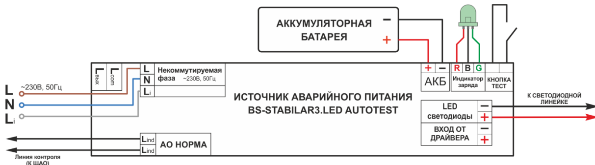
Рис. 2 Схема подключения BS-STABILAR3-81-B2-LED и BS-STABILAR3-83-B2-LED для аварийного светового прибора в непостоянном режиме:
