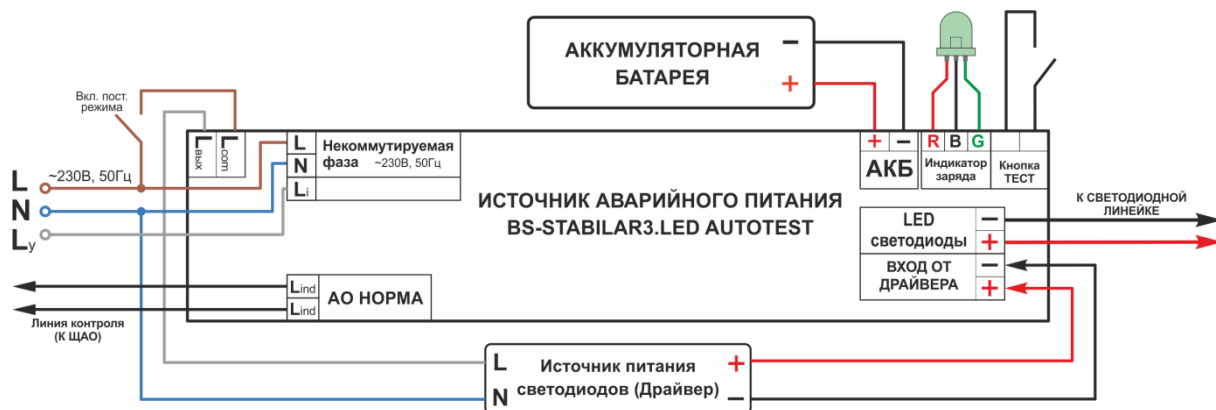
Рис. 2 Схема подключения BS-STABILAR3-81-B1-LED и BS-STABILAR3-83-B1-LED для аварийного светового прибора в непостоянном режиме:
