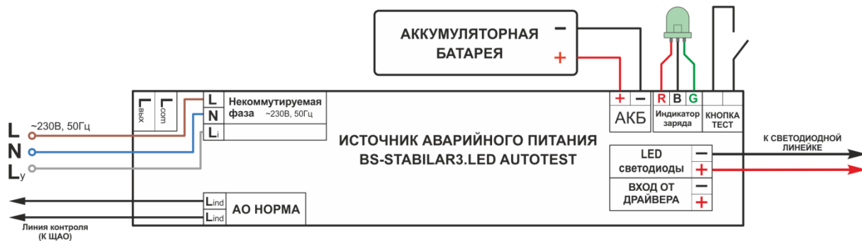
Рис. 2 Схема подключения BS-STABILAR3-81-B1-LED и BS-STABILAR3-83-B1-LED для аварийного светового прибора в непостоянном режиме:
