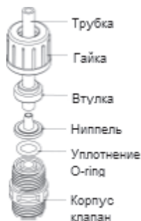
Рис. 13 Подключение трубопроводов
