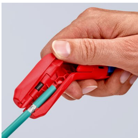
Удаление оболочки с дата-кабеля
