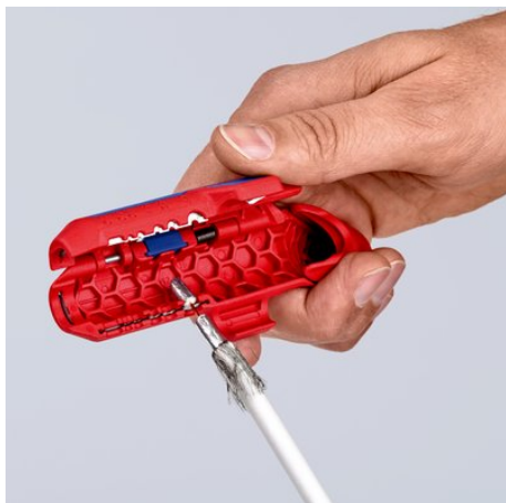
Удаление изоляции с коаксиального кабеля
