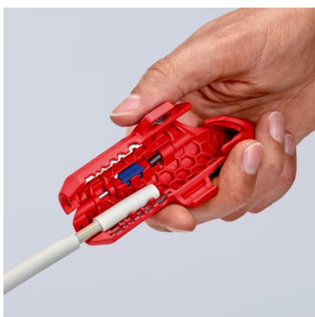
удаление оболочки с провода NYM
