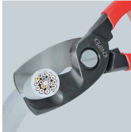
Первичный рез: Благодаря использованию передней режущей кромки для резки изоляционного материала
