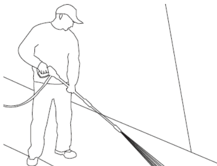
Рис. 7 – Оптимальный угол падения струи на очищаемую поверхность
